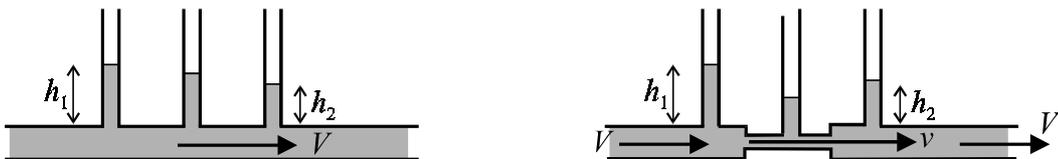
fig. 12.4 : La perte de charge  $\Rightarrow h_2 < h_1$ .
