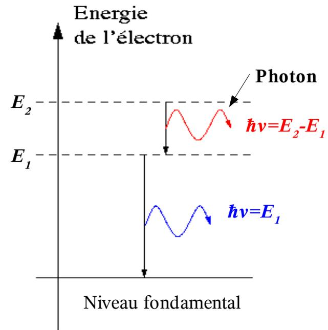
Le photon porte une quantité d'énergie déterminée. La longueur d'onde perçue est fonction de cette énergie.
