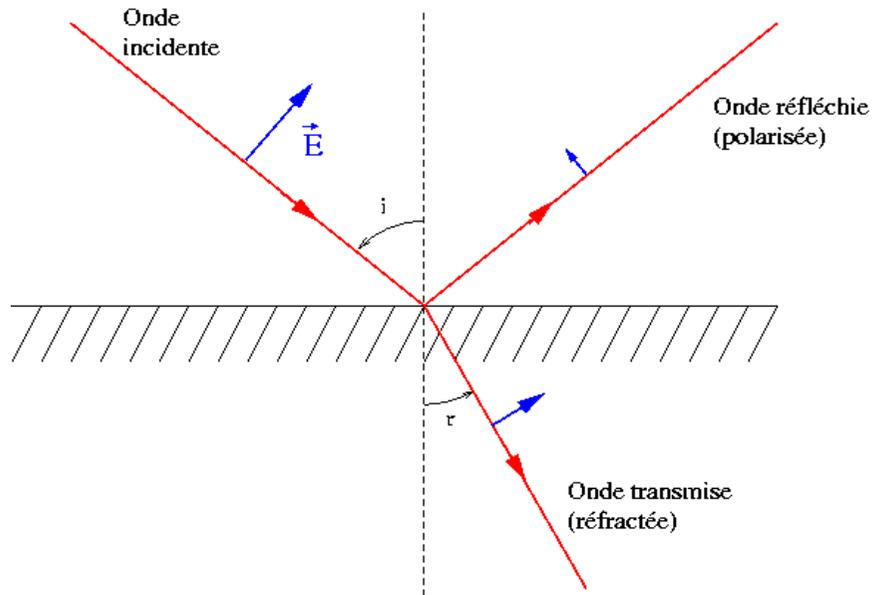
La composante du champ électrique perpendiculaire au plan du verre est atténuée pour l'onde réfléchie. Elle s'annule pour un angle d'incidence dit de **Brewster**. La lumière réfléchie est alors **complètement polarisée** (linéairement, parallèlement au plan du verre).
